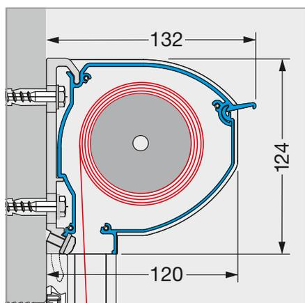
Die Schienen bzw. Seilhalterungen der MICRO 200 werden an der Wand befestigt, die Kassette wahlweise an Decke oder Wand.
