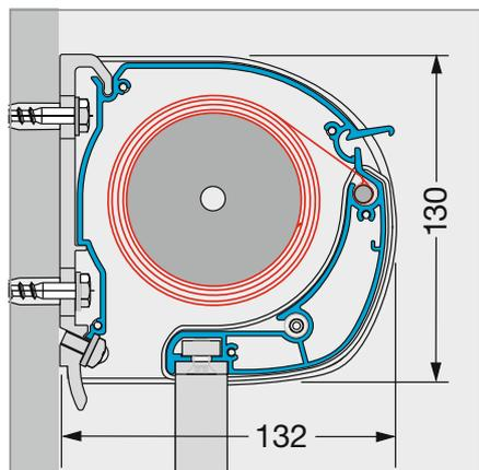
Standardmäßig wird die MICRO 100 mit Motorantrieb geliefert.
